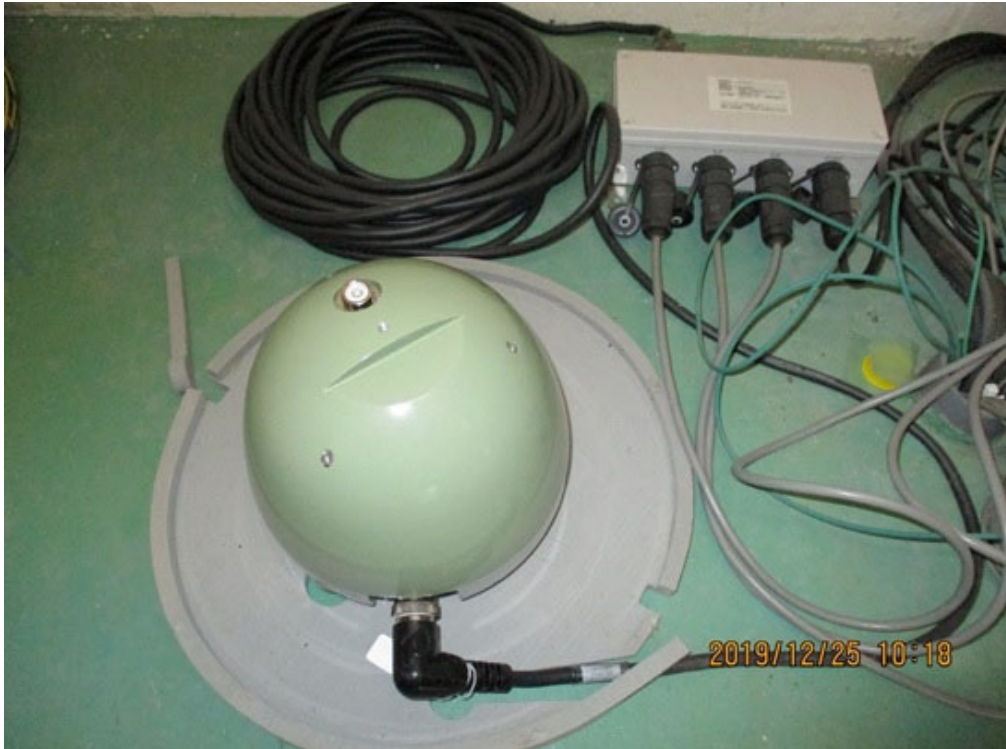
図 1.1-1-4 新島観測点に設置した広帯域地震計
