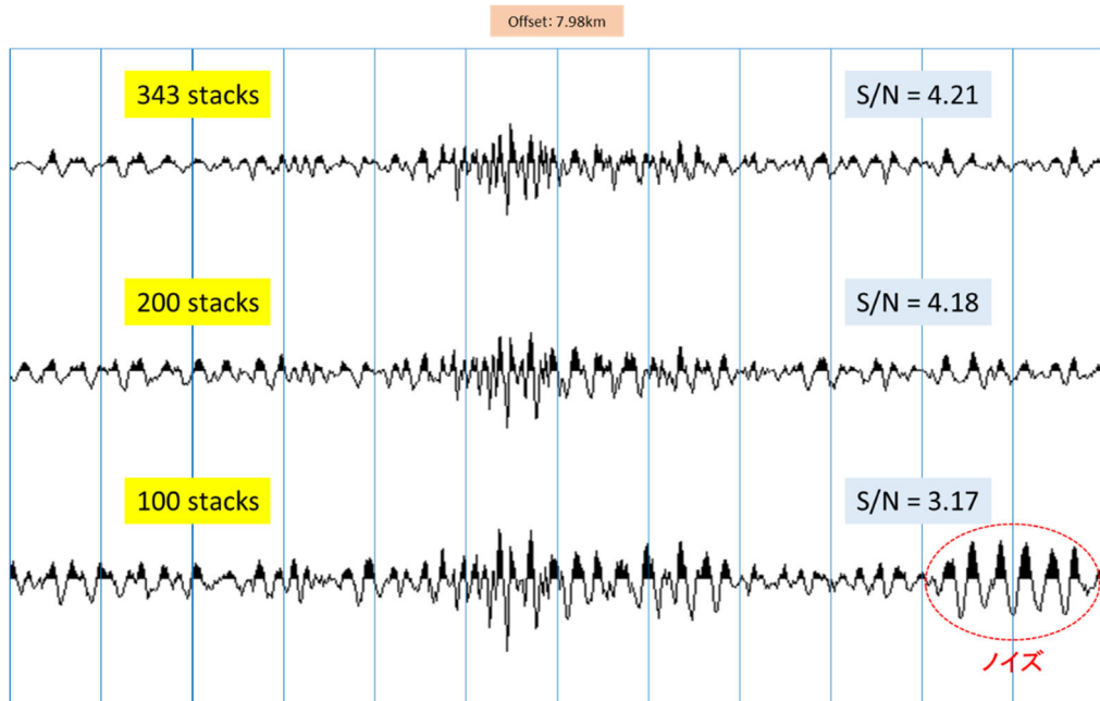
図 1.2-2-14 高免 (KOM) V 成分の Correlation After Stack の効果。
