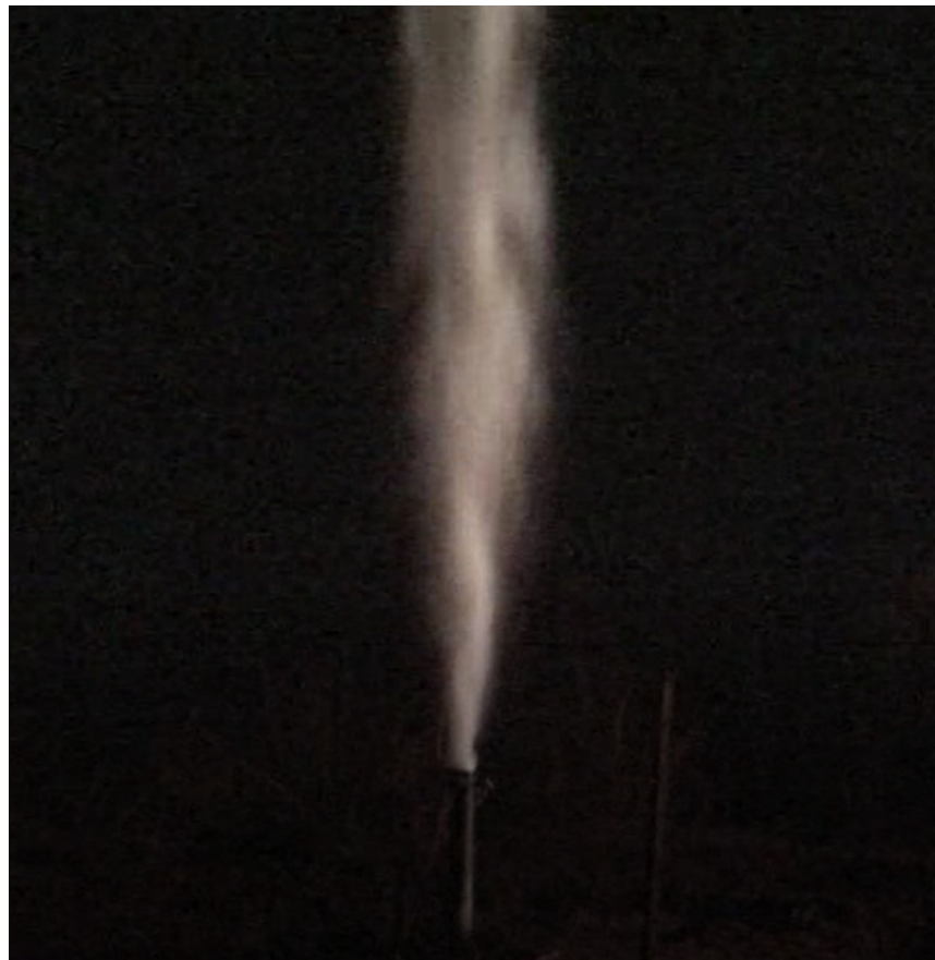
図1.2-2-1 発破による人工振源。薬量20 kg 爆破の瞬間。孔中にダイナマイトを装薬する。孔中の爆薬の燃焼により人工的に地震波を発生する。
