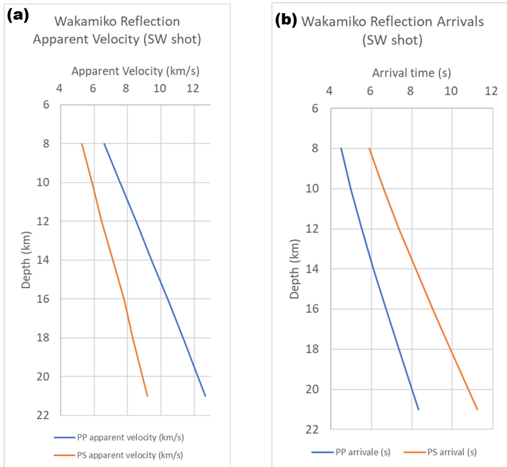
図 1.2-1-19 (a) アレイ L15 における各深さからの反射波および変換反射波の理論走時, (b) アレイ L15 における各深さからの 反射波および変換反射波の理論見かけ速度。
