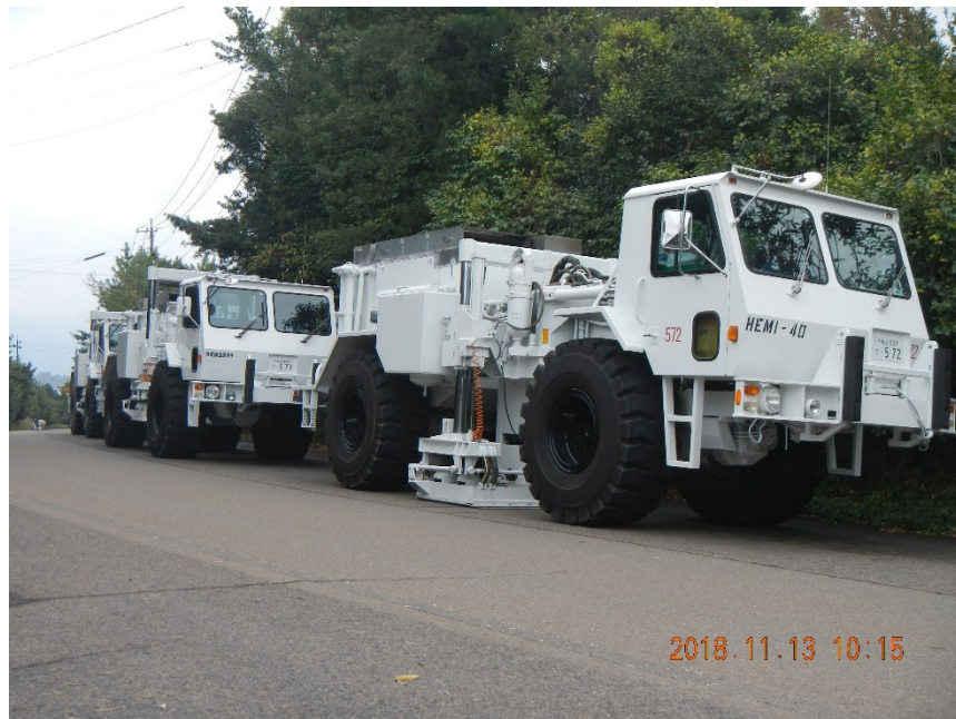
図 1.2-2-3 バイブレータ。HEMI：全長 8.4 m，全幅 2.4 m，全高 3.2 m，全重量 18.9 ton. 車両に搭載された油圧機構によって人工的に地震波を発生させる。
