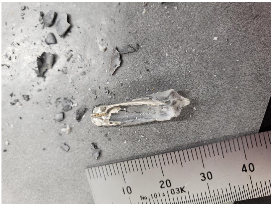
図 2.6.2-2 HG592, CG224 の実験後におけるバッファカプセル(Pt 5.0-4.6mm \phi )と BN スリーブの様子．
