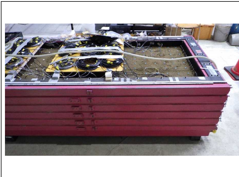
28. 砂礫土締め完了
