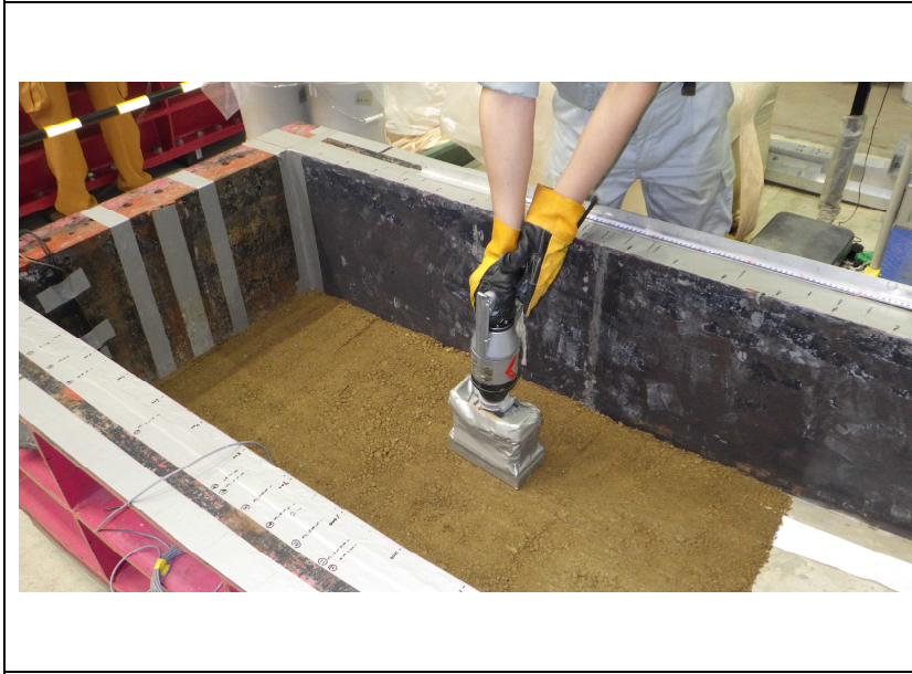
8. 砂礫土締固め
