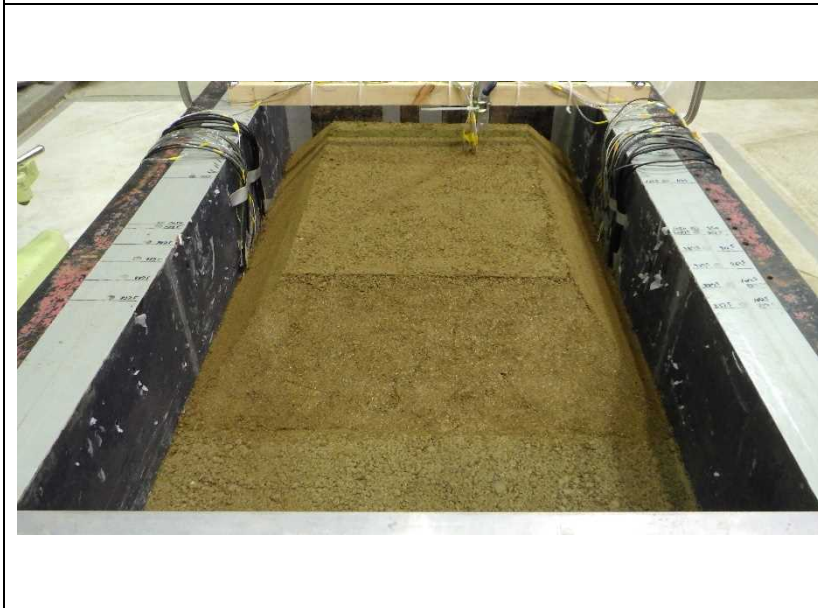
9. ケーソン背後の盛土完了
