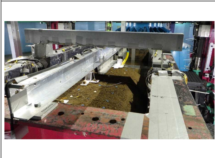
14. 変位計治具設置
