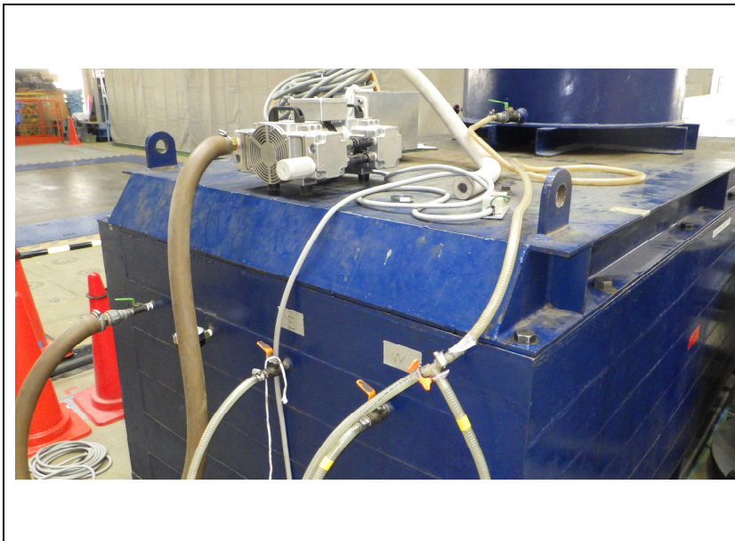
19. 脱気、注水の真空土槽
