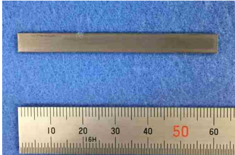
図 3. 2. 2-1 純 Ta 圧延材短冊試験片の外観
