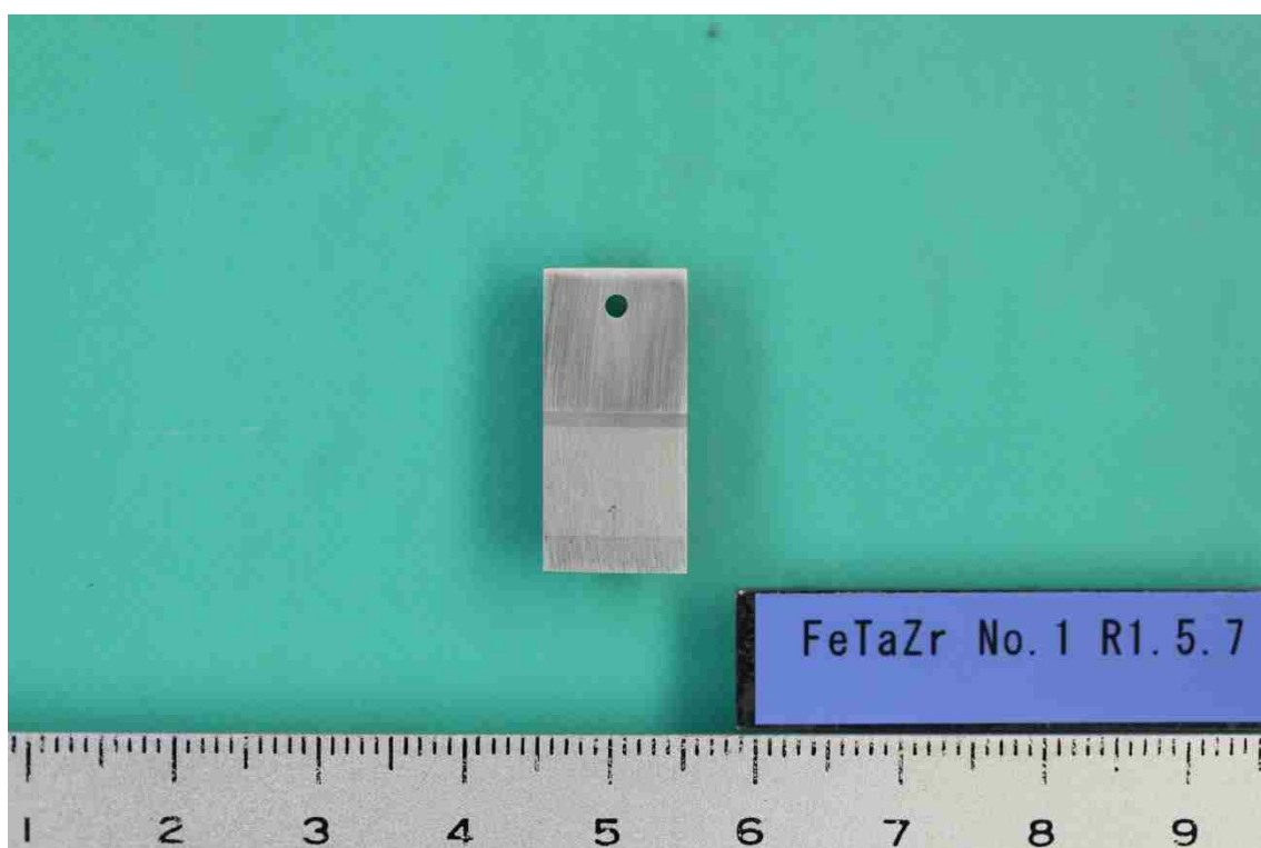
(b) 実機相当異材接合材腐食試験片の外観写真
