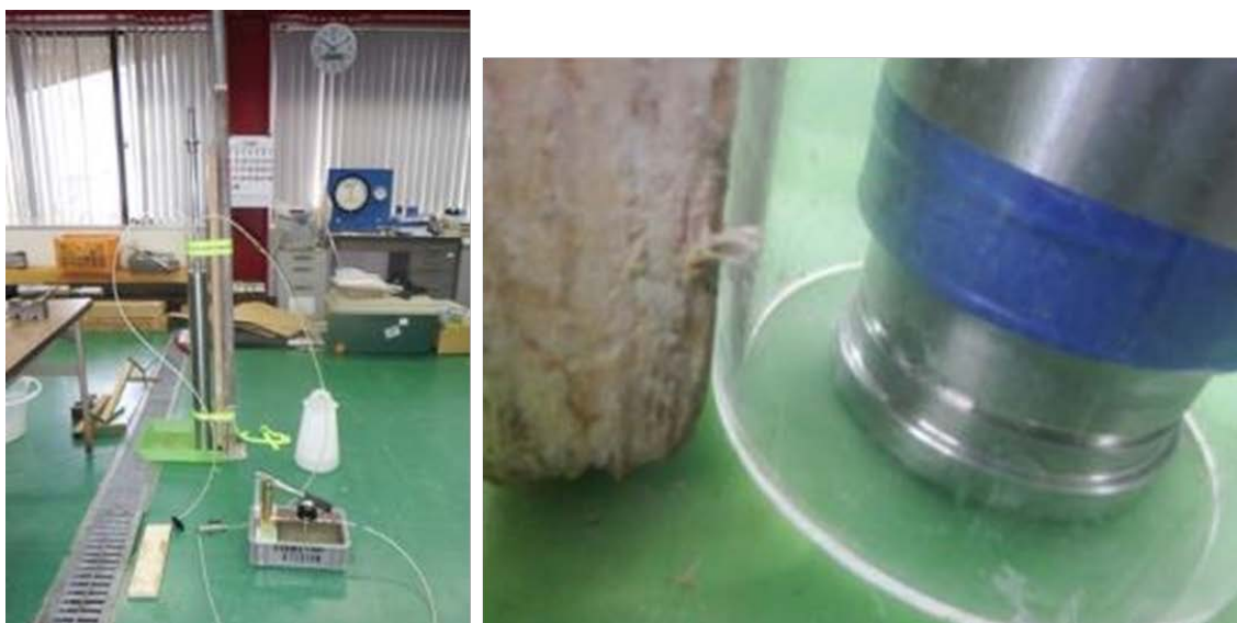
付図III-C.2-1 要素試験の状況（左：注水試験の様子、右：せん断ピン破断後の様子）
