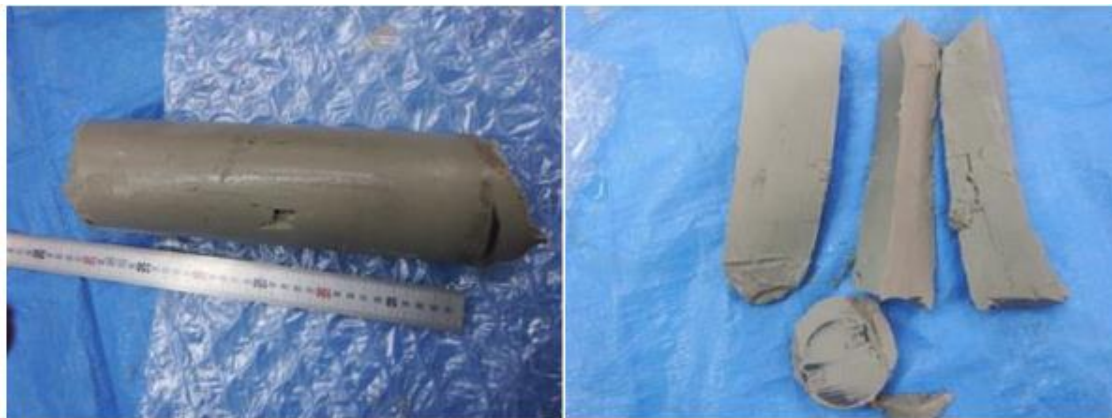
図 4.2-10 試験①のブロック 2つのケースにおいてアクリル管内から回収したブロック
