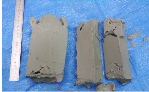
図 4.2-7 アクリル管内から回収したブロック（試験①のブロック 1つのケース）
