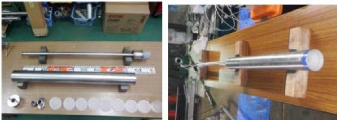
付図III-C.1-2 閉塞材挿入プローブ（左：組立前、右：組立後）
