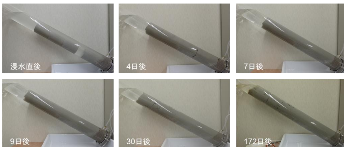
図 4.2-12 試験②のブロックを4つ投入したケースのブロックの膨潤の様子
