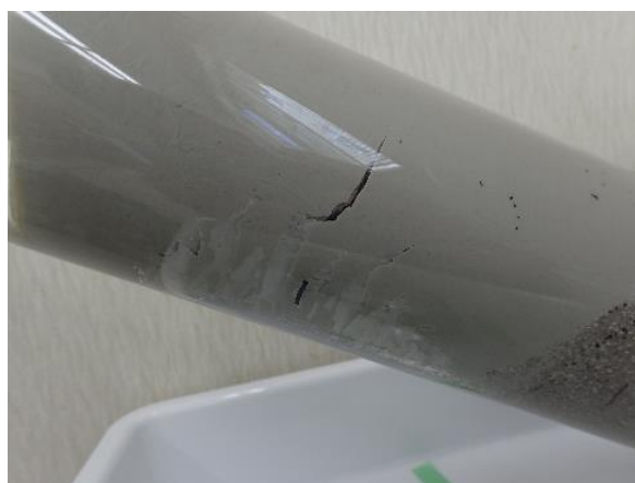
図 4.2-13 試験②のブロックを 1 つ投入したケースにおいてブロックに発生した割れ目
