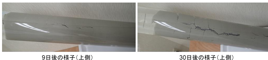
図 4.2-14 試験②のブロックを 4 つ投入したケースにおいてブロックに発生した割れ目
