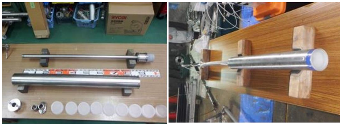
図 4.3-10 閉塞材挿入プローブ（左：組立前、右：組立後）
