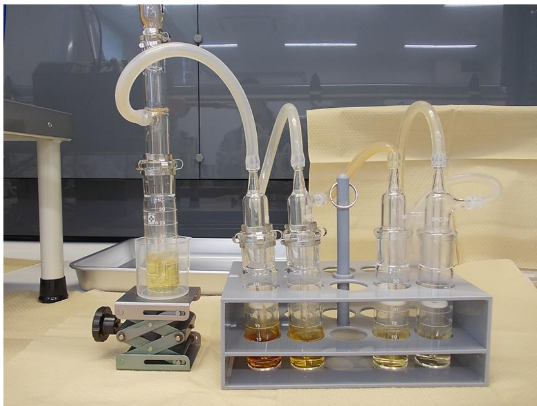
図 2.2-7 1,000 °C 加熱試験時のトラップの様子
