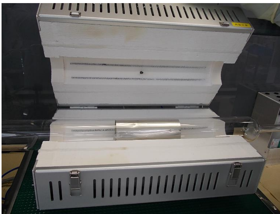
図 2.2-2 試料挿入後の電気炉内の様子
