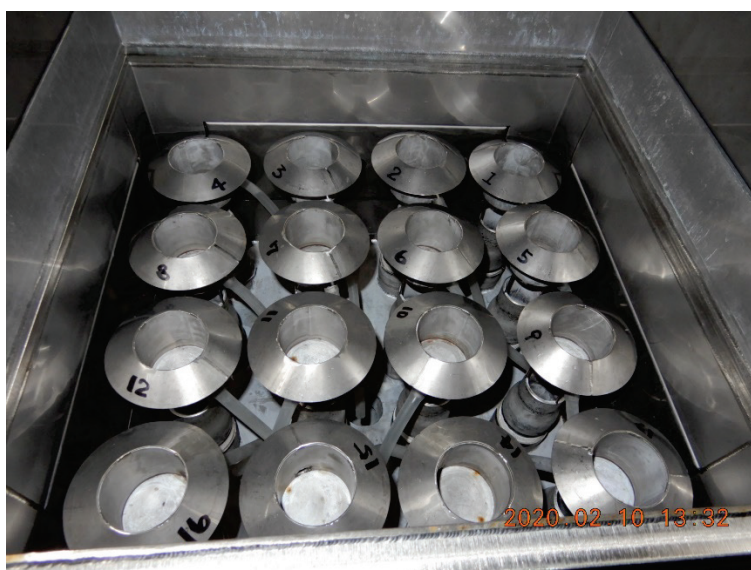
図 4.3.3-3 試験部底部に設けられたエアゾルガス注入部の写真
