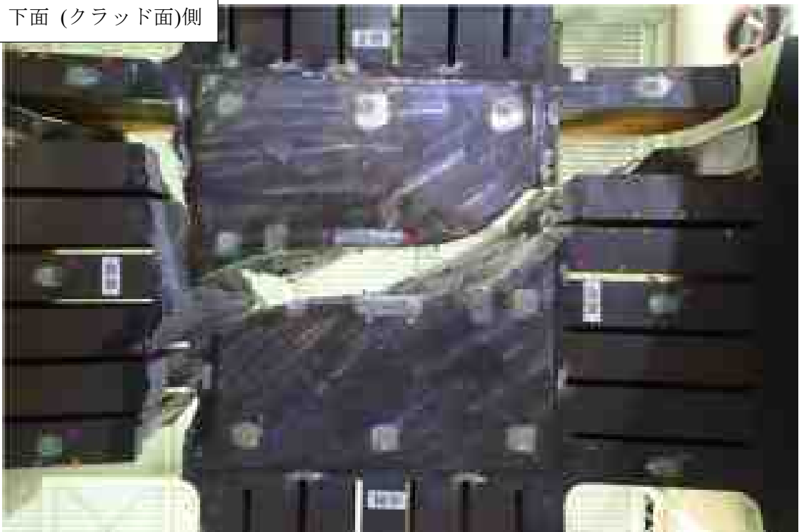
図 8 試験後の試験体外観状況
