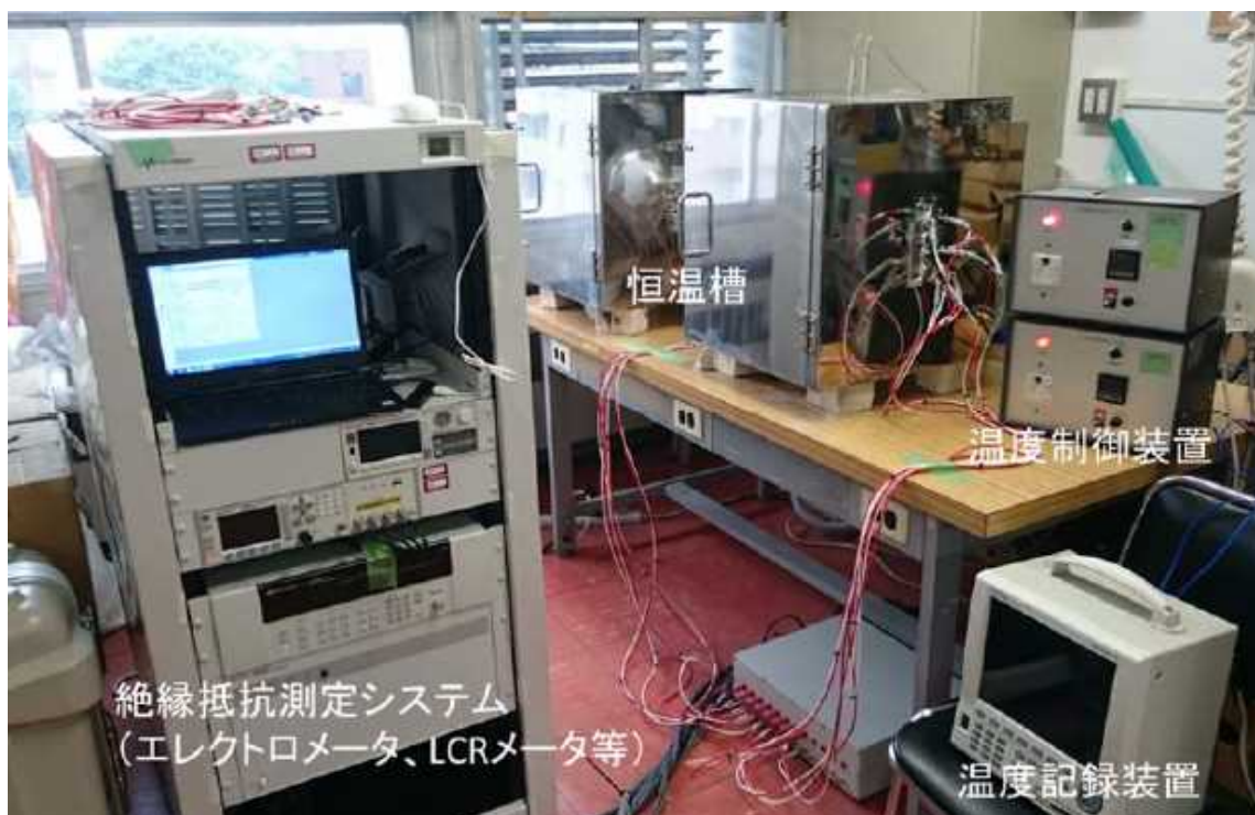
図 2.3.2.2 ケーブル大気中加熱試験の装置
