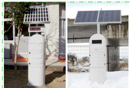
リアルタイム線量測定システム (福島県内 2,983台)
