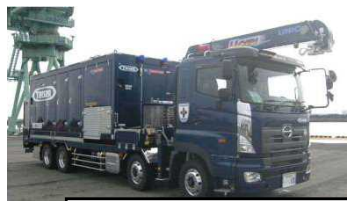
可搬型代替注水大型ポンプ(放水用)
