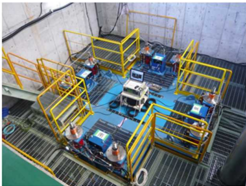
ピット内へ設置した荷重負荷機構部
