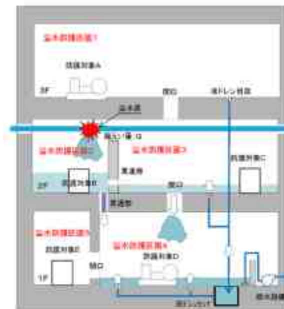
図10. 漏水設備の対策区画の分離例
