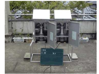
浮遊じんの採取 (ハイポリウムエアサンプラ)
