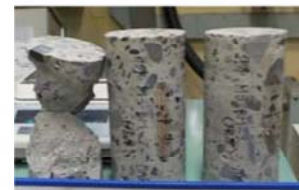
大きく破壊されたコアサンプル(左端)
