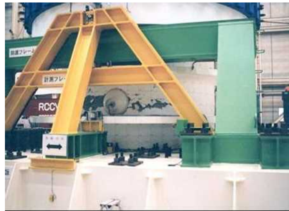
図3 大型振動台のコンクリート製格納容器（RCCV）の試験体の耐震限界試験の例
