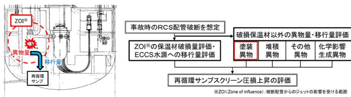
図 事故時の格納容器再循環サンプスクリーン性能評価・ZOI概要
