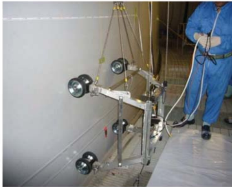
図3. 5 円筒部外面 遠隔目視用点検装置
