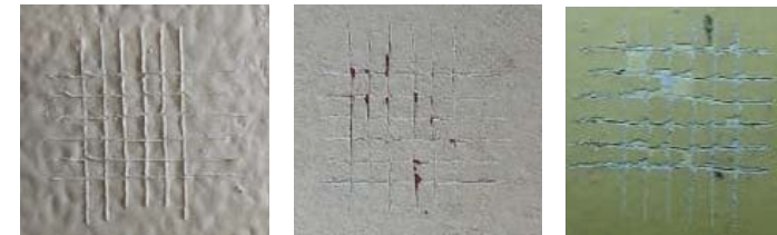
試験結果の例 (左から、評価分類0、1、2)
