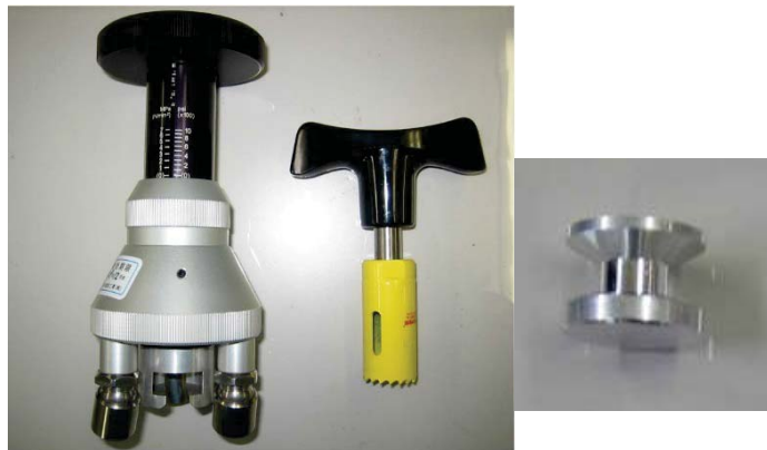
プルオフ法の試験機材 (左:付着性試験器、中:ドリルカッター、右:ドリル)
