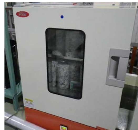
遮蔽能力の点検状況 (コアサンプルの乾燥状況)
