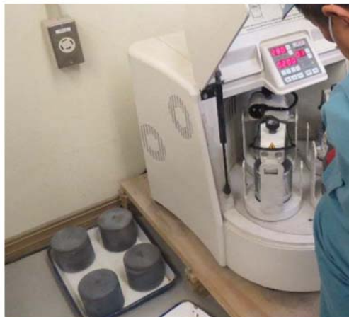
コンクリートの微粉碎状況
