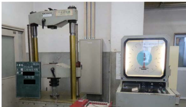
圧縮強度試験の状況(構外試験室)
