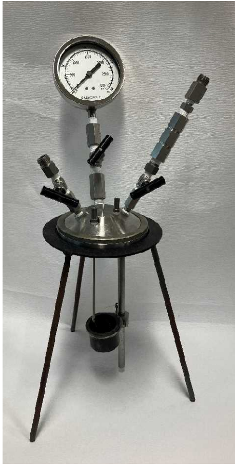
図4-2 迅速試料燃焼装置の写真（左は組み立て前、右は組み立て後）
