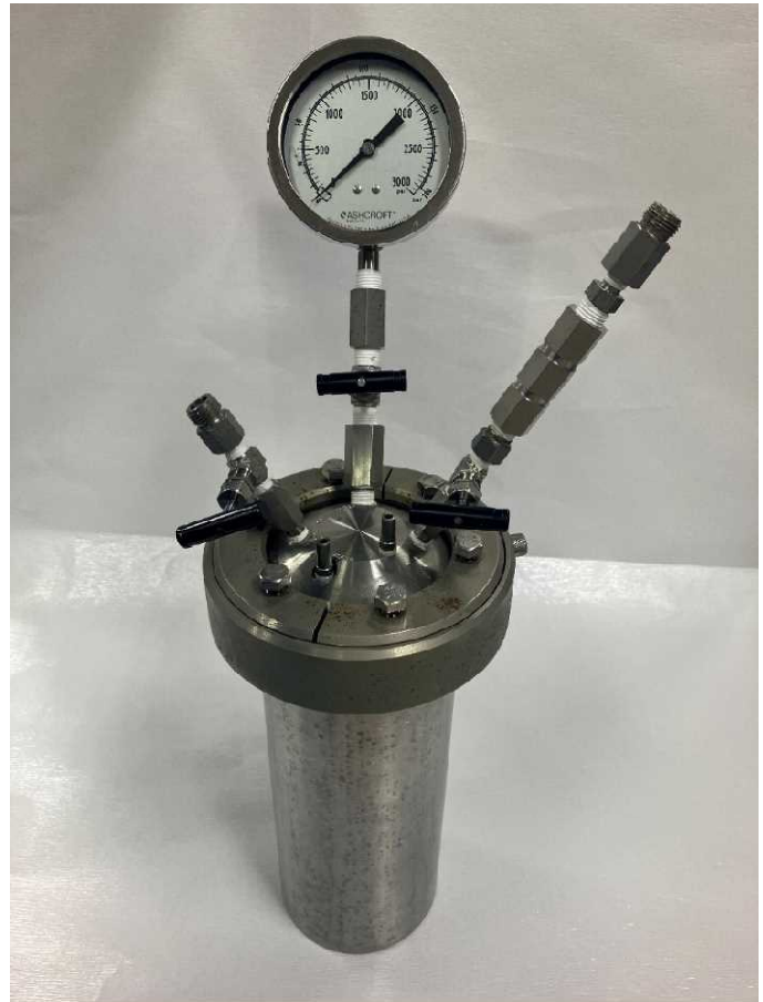
図4-2 迅速試料燃焼装置の写真（左は組み立て前、右は組み立て後）
