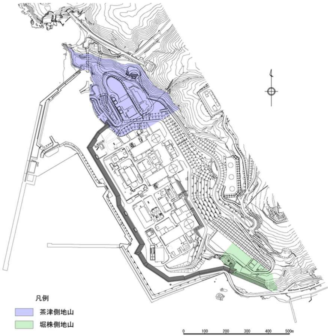
図 2.1. a. b-4 防潮堤（茶津側）及び防潮堤（堀株側）の地山
