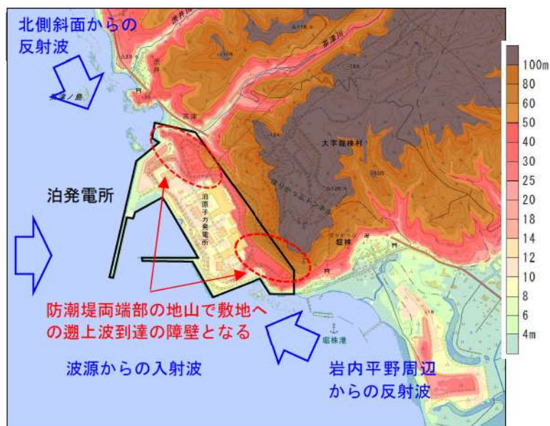
図 1.1. a. b-1 (1) 津波の敷地への到達経路※
