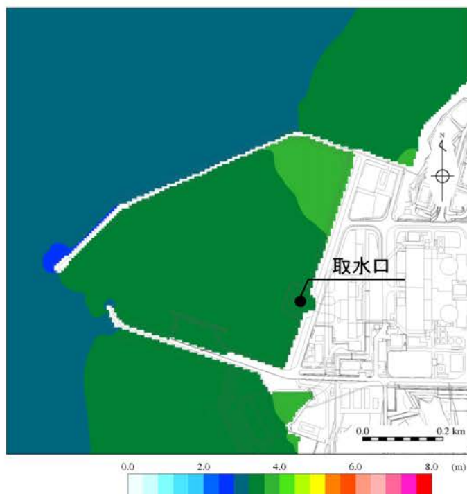
第 3.1.3.4-9 図 基準津波の最大水位上昇量分布(初期潮位: T.P. ± 0.00m) (1/2)
