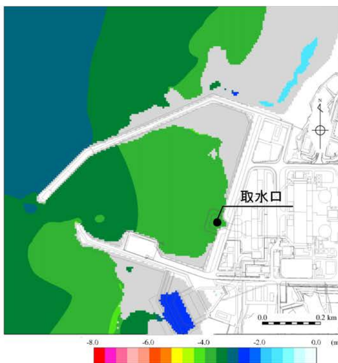
第 3.1.3.4-9 図 基準津波の最大水位下降量分布(初期潮位: T.P. ± 0.00m) (2/2)
