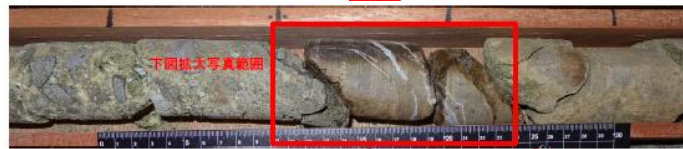
H-3(F-3)断層: B-2e孔, 深度40.35~20.75m (平成29年撮影)
