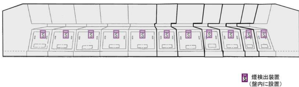
図 2.4.3 中央制御盤 煙検出装置配置
