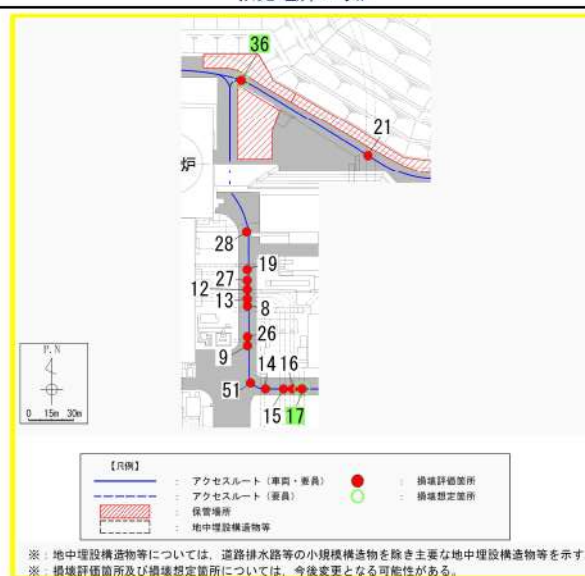
第6-44図 構造物損壊による段差発生想定箇所 (3/5) (Bエリア)
