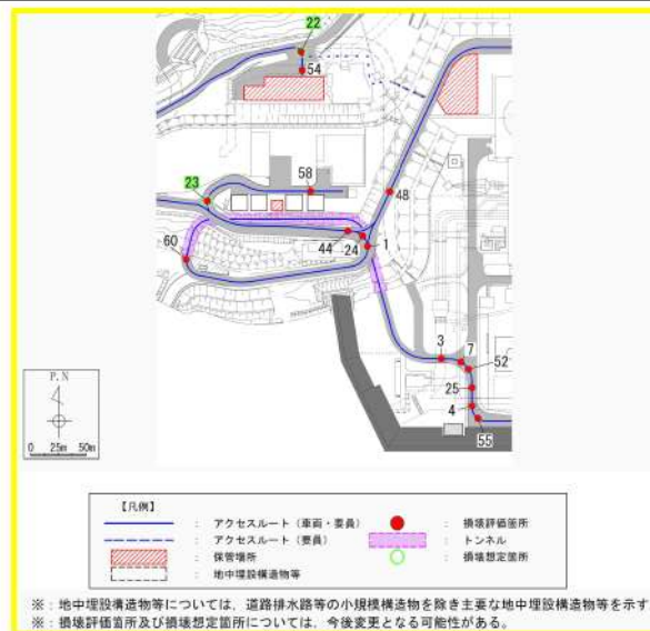
第 6-44 図 構造物損壊による段差発生想定箇所 (2/5) (A エリア)
