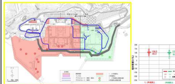
第5-5図 埋戻土の相対密度調査位置及び調査結果
