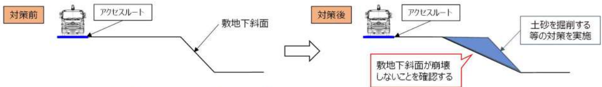
第 7.2-1 図 敷地下斜面に対する土砂掘削等の対策
