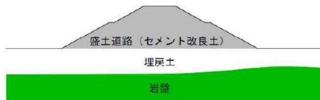
第 6-29 図 C-C' 概略断面図
