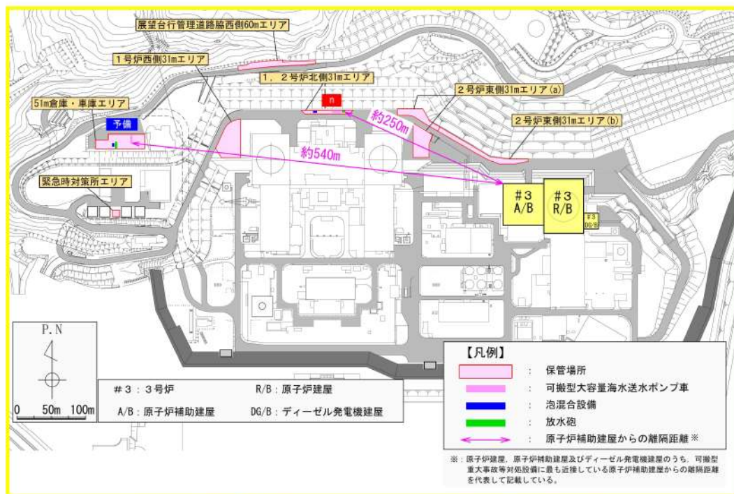
可搬型大容量海水送水ポンプ車，泡混合設備及び放水砲と 原子炉補助建屋との離隔距離
