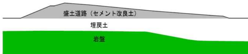
第 6-28 図 B-B' 概略断面図
