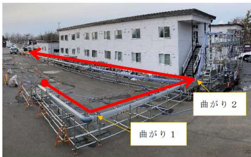
添付 5-4(2) 図 モックアップ試験装置の全景（ルート 2）
