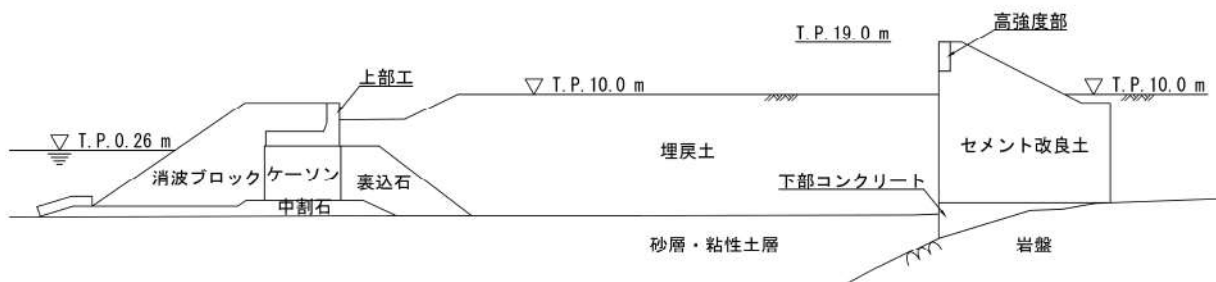
第 5-5 図 防潮堤（標準部）の横断図
