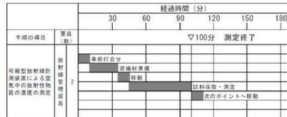
第1.17-9図 可搬型放射線計測装置による空気中の放射性物質の濃度の測定のタイムチャート
