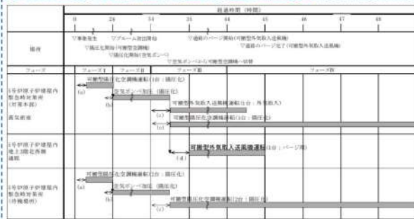
図 3.2-11 5号炉原子炉建屋内緊急時対策所における換気設備の運用全体像
