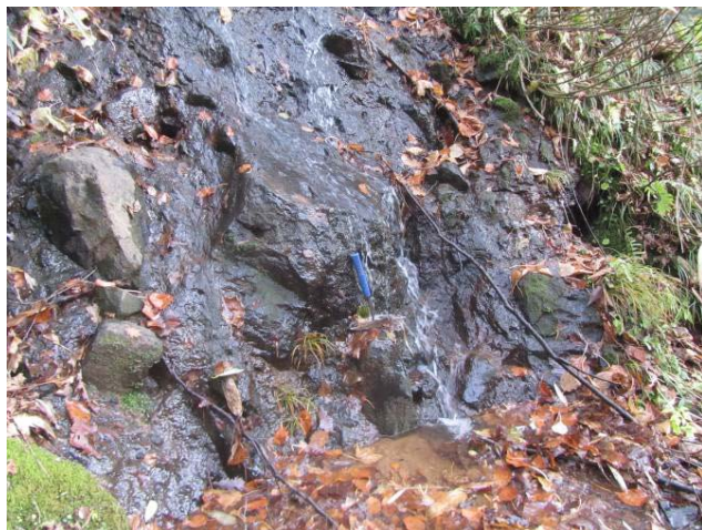
ON5: 中流左岸の支流合流部に分布する神恵内層の自破碎溶岩。
