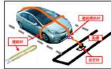
図1 セダンタイプの固縛方法イメージ
