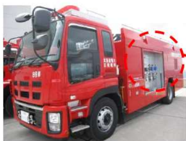
②可搬型大型送水ポンプ車の吸込み部（水中ポンプからのホース接続部）
