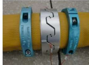
可搬型ホース(150A)接続後
