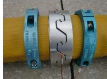
可搬型ホース (150A) 接続後
