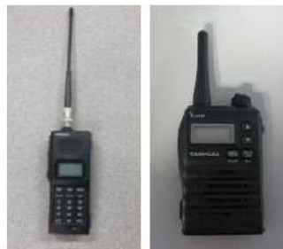
無線連絡設備 無線連絡設備（携帯型）
