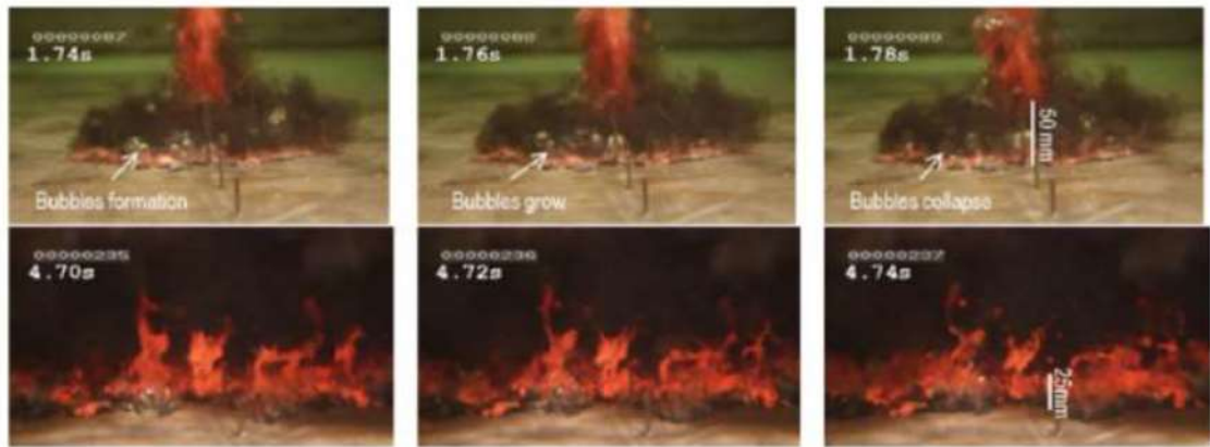
図 3.1-55 PULiMS-E4 試験での溶融物拡がり挙動
