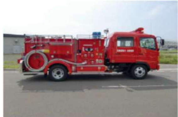
第 2 図：水槽付消防ポンプ自動車
