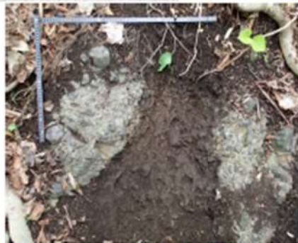
P4 防災科研調査において地滑り土塊とされる箇所の露岩状況 堅硬な岩盤(凝灰角礫岩)が認められる。
