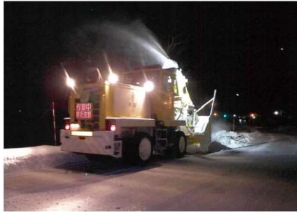
第4-1図 重機による除雪作業（1）
