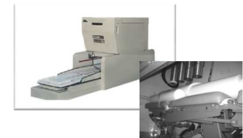
ホールボディカウンタ等設備整備
