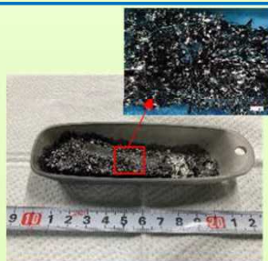
試験後 (1000°C水素ガス環境下)
