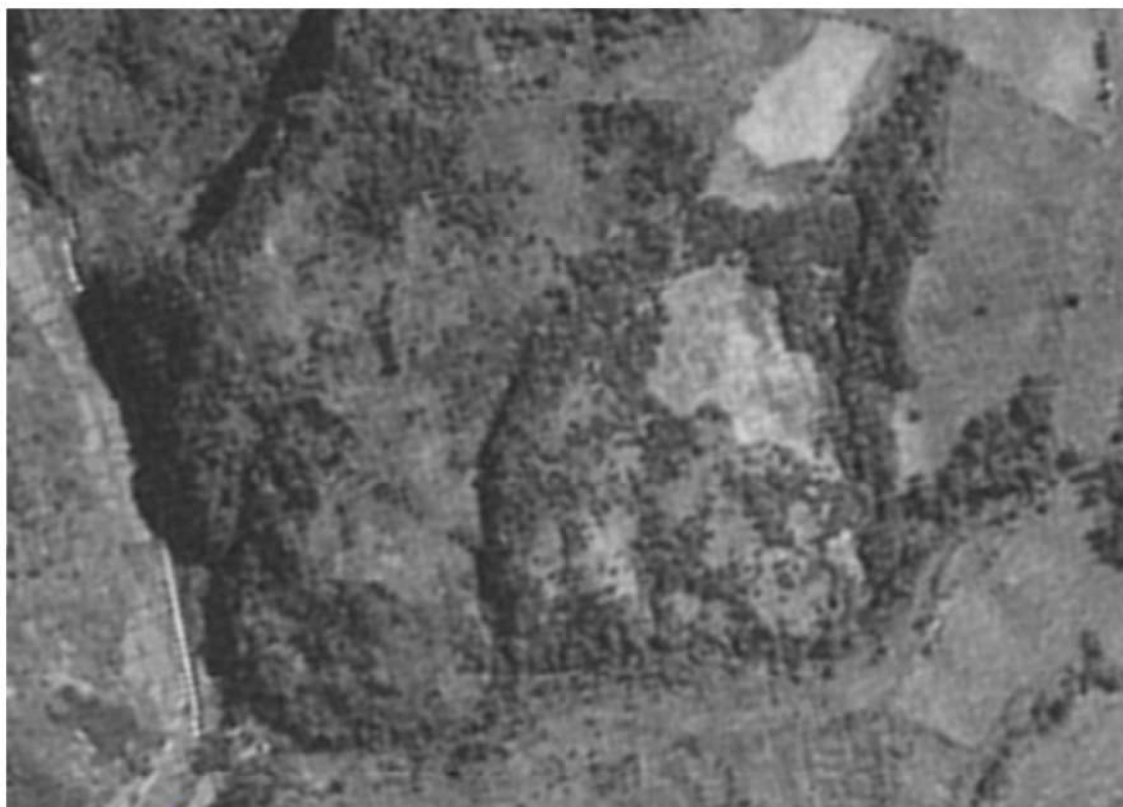
参考図5-2 防災科研調査が判読に用いた地滑り地形②周辺の空中写真 （撮影縮尺4万分の1，1965年撮影）
