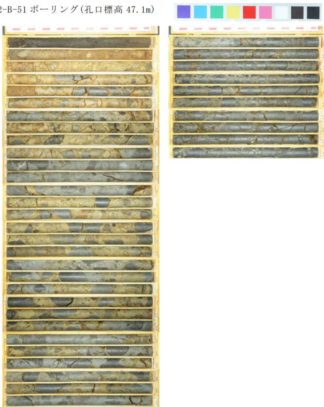
図 2.1. a. c-7 (8) 防潮堤(掘株側) ボーリングコア写真 鉛直ボーリング (L=40m)
