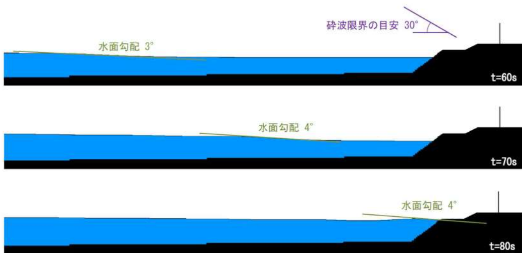
第19図 護岸における水面勾配（第2波模擬津波）
