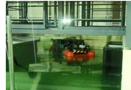
ROV航走試験 (狭隘部通過)
