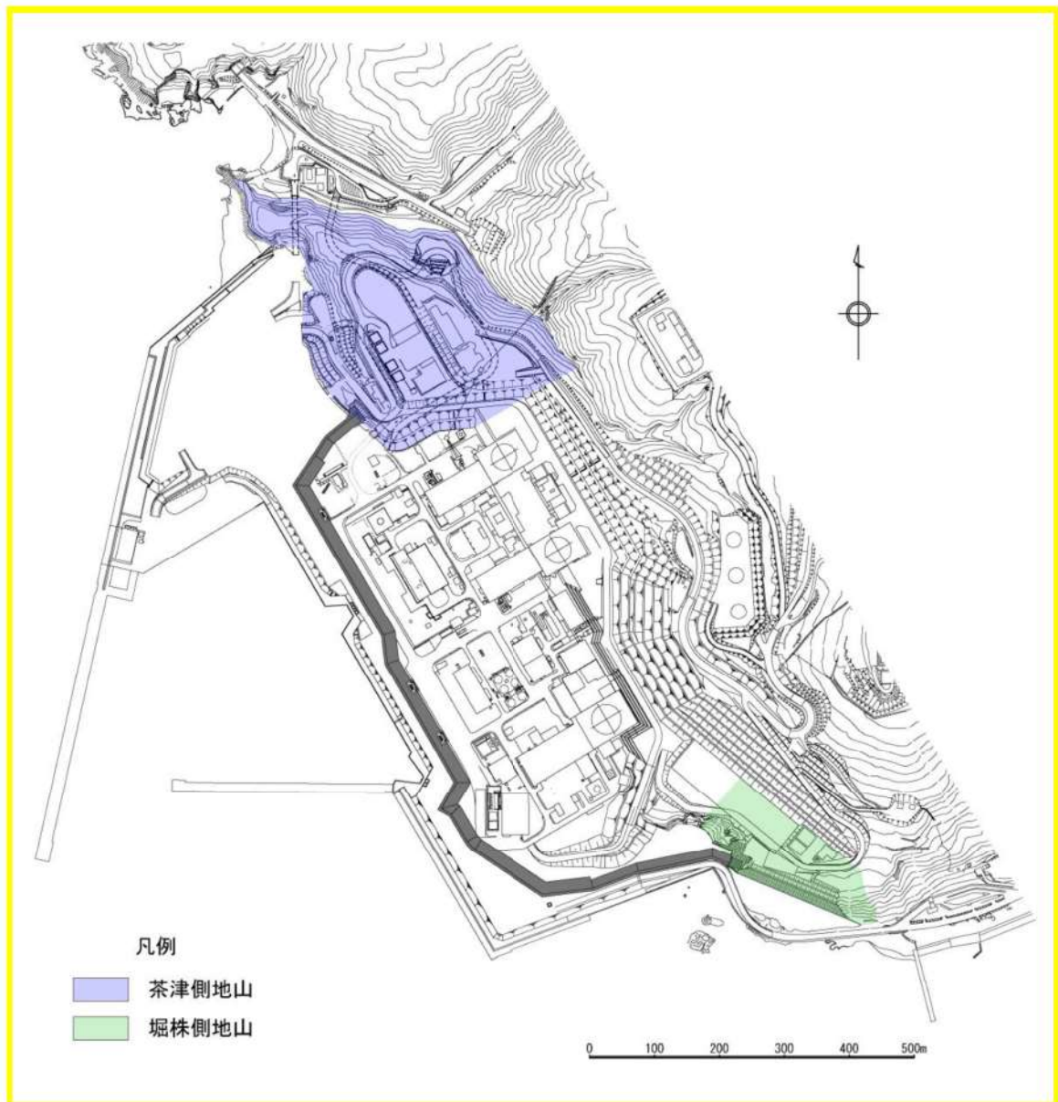
図 2.1. a. b-4 防潮堤（茶津側）及び防潮堤（堀株側）の地山
