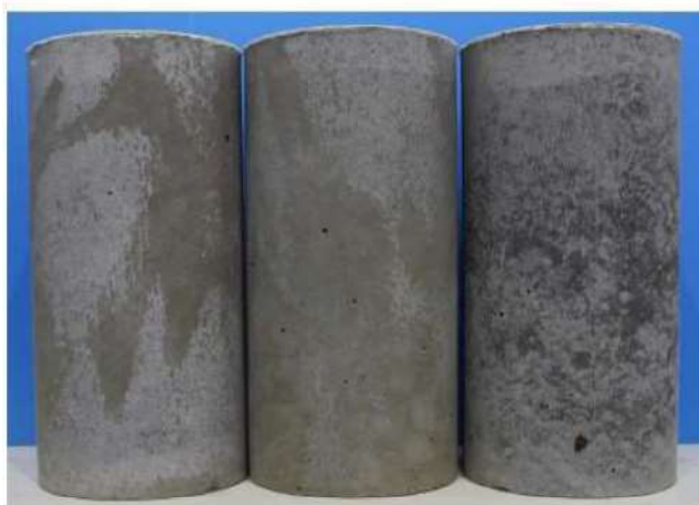
第 7-48 図 セメント改良土の室内試験用供試体 ( \phi 150\text{mm} , H300mm)
