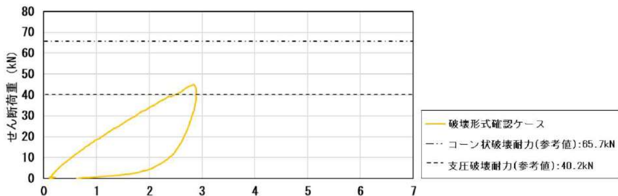
第 7-67 図 アンカーボルトの水平変位 破壊形式確認ケース (mm)
