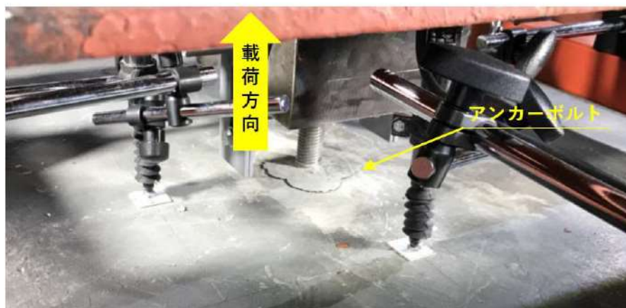
第 7-60 図 引張試験1-4 最大荷重載荷時の状況写真
