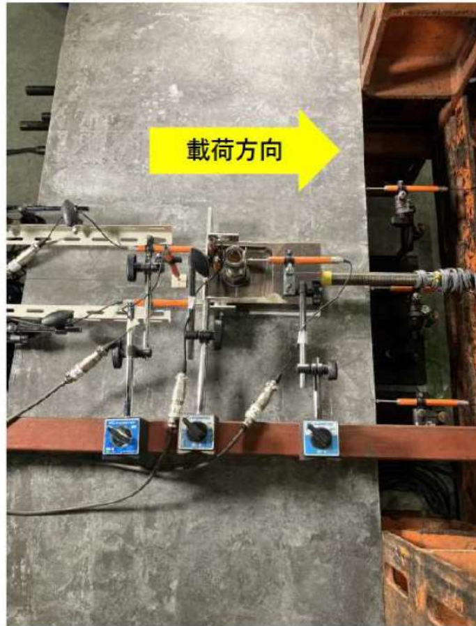
第 7-65 図 せん断試験最大荷重載荷後の状況写真（せん断 3）
