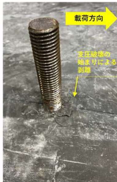
第 7-69 図 せん断試験後の状況写真 (破壊形式確認ケース)
