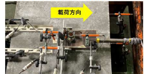
せん断試験最大荷重载荷後の状況写真
