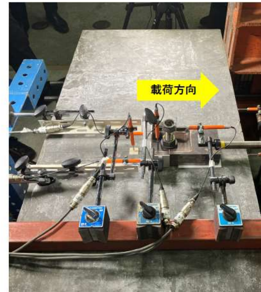
せん断試験最大荷重載荷後の状況写真
