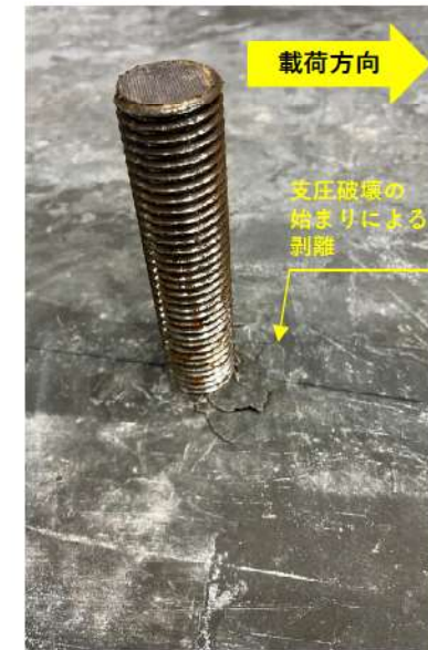
せん断試験後の状況写真
